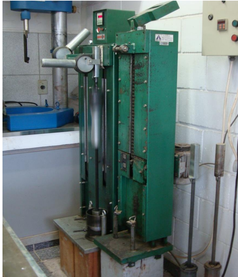
Figura 15: prensa Marshall para compactação dos CP
