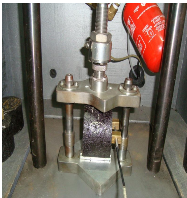
Figura 19: CP no ensaio de módulo de resiliência
