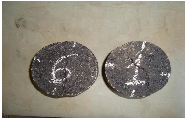
Figura 18: CP após ensaiado à tração
