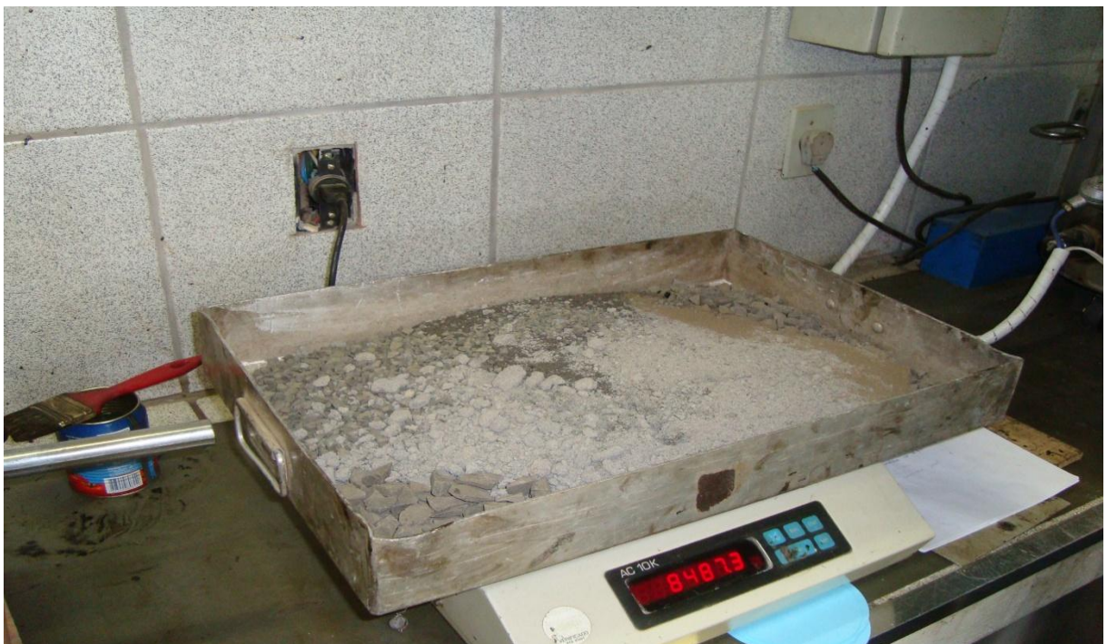
Figura 14: material sendo separado nas frações de moldagem
