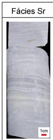
**Figura 26:** Fácies Sr - Arenito com laminação cruzada de marcas onduladas, com ângulo de cavalgamento subcrítico. Algumas porções com bioturbação de grau moderado.
