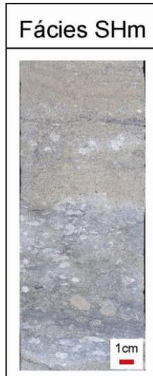
**Figura 32:** Fácies SHm - Arenito híbrido maciço, com bioclastos e oncólitos retrabalhados, fragmentos carbonosos e intraclastos carbonáticos dispersos, concentração de grânulos de quartzo, feldspato e granada. Intensamente bioturbado.
