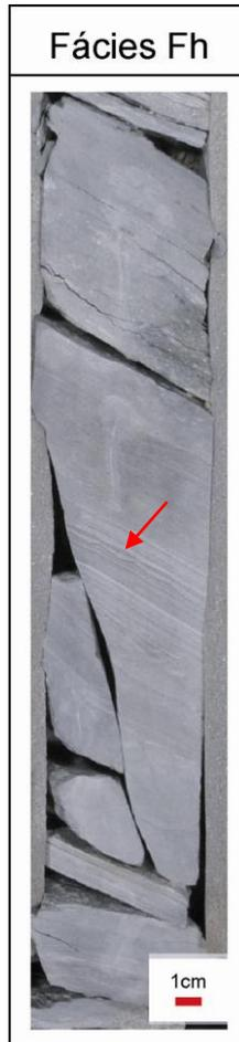
**Figura 29:** Fácies Fh - Siltito com laminação horizontal, porção com baixo grau de bioturbação e algumas estruturas de carga (flecha vermelha). Apresenta falhamento.
