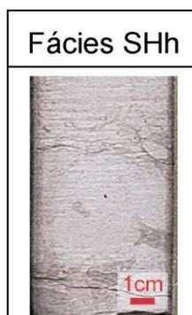
**Figura 33:** Fácies SHh - Arenito com laminação horizontal. Bioturbação de baixa intensidade.
