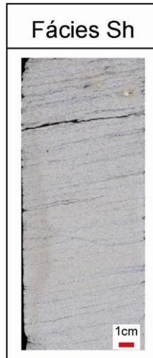
**Figura 23:** Fácies Sh - Arenito com laminação horizontal, com fragmentos carbonosos e de matéria orgânica marcando a laminação, presença de grânulo de granada.
