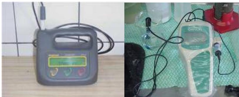
**Figura 28: Equipamentos utilizados no monitoramento-OD, temperatura e pH.**
