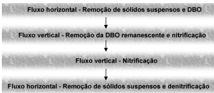
**Figura 6: Arranjo do sistema híbrido - fluxo horizontal e vertical.**
