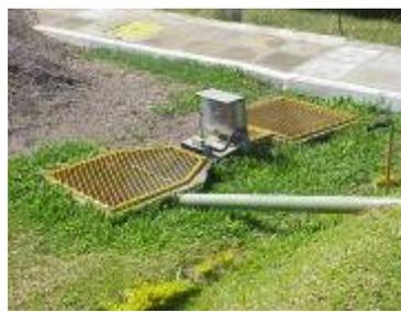
**Figura 35: Instrumentos de medição de vazão no piloto: hidrômetro Danfoss (1); calha Parshall (2).**
