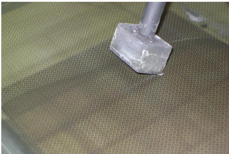
Figura 4.19. Gravação dos círculos para exame de visioplasticidade
