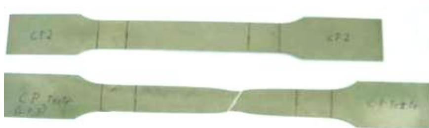
Figura 3.5. Fratura dútil da chapa (sentido de laminação paralelo ao corpo de prova), caracterizada pelo ângulo de ruptura (aprox.  $45^\circ$ ) e pela estrição visível.
