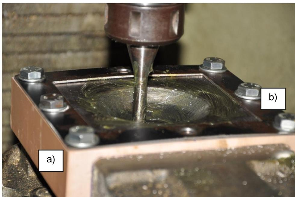
Figura 4.3. a)polímero utilizado como suporte inferior; b)placa prensa-chapas.
