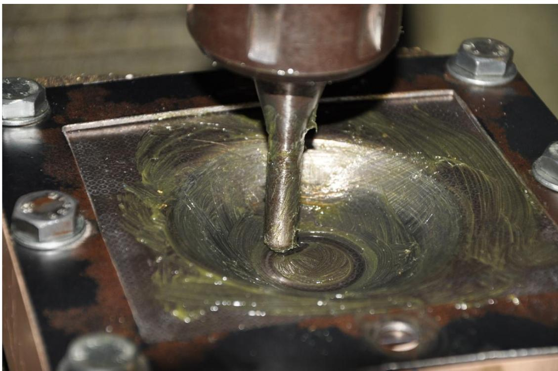
Figura 4.11. Lubrificação no processo de estampagem incremental
