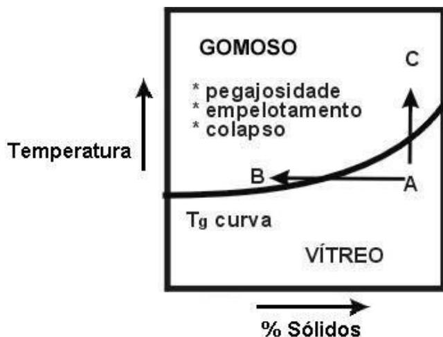
**Figura 6** - Diagrama representativo da transição entre os estados vítreo e gomoso.
