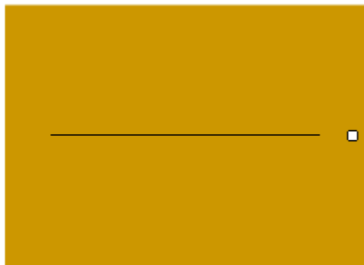
Figura 8 - Representação de placa de aço revestida e pintada, com corte, para ensaio de migração de acordo com a norma NBR MB 787-74.
