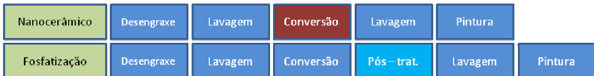
Figura 2 - Comparação do processo de revestimento nanoestruturado vs. revestimento de fosfato - adaptado de Fristad, 2006.
