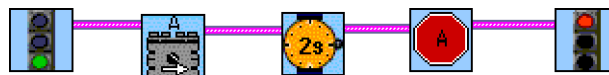
Figura 14: Quarta programação construída pelo Sujeito 1: Início da programação / Motor A gira para a direita / Durante 2 segundos / Desliga motor A / Fim da programação. Fonte: Dados da pesquisa.
