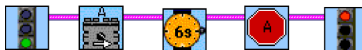
Figura 46: Segunda programação construída pelo Sujeito 6: Início da programação / Motor A gira para a direita / Durante 6 segundos / Desliga motor A / Fim da programação. Fonte: Dados da pesquisa.
