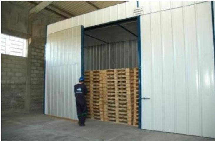
**Figura 4** - Estufa de Metal para Tratamento Térmico (HT)
