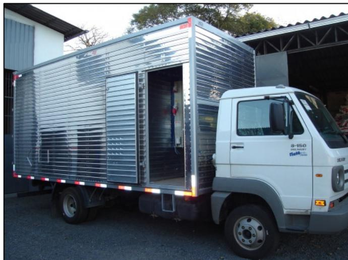
**Figura 7** - Unidade Móvel de Fumigação
