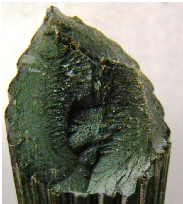
Figura 4.7. Região fraturada em fadiga da peça sem revenimento.
