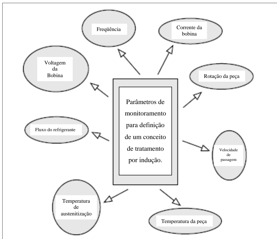
Figura 2.4. Parâmetros de monitoramento para definição de um conceito de tratamento por indução. Fonte: Practical Induction Heat Treating 2001.
