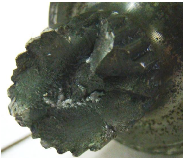
Figura 4.6. Região fraturada em fadiga da peça revenida em forno.
