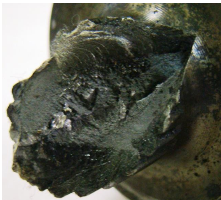
Figura 4.5. Região fraturada em fadiga da peça revenida por indução.
