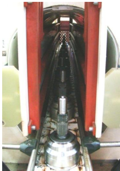
Figura 3.2. Forno de indução M1812.
