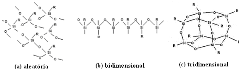
Figura 4: Estruturas dos silsesquioxanos: (a) aleatória, (b) bidimensional e (c) tridimensional.
