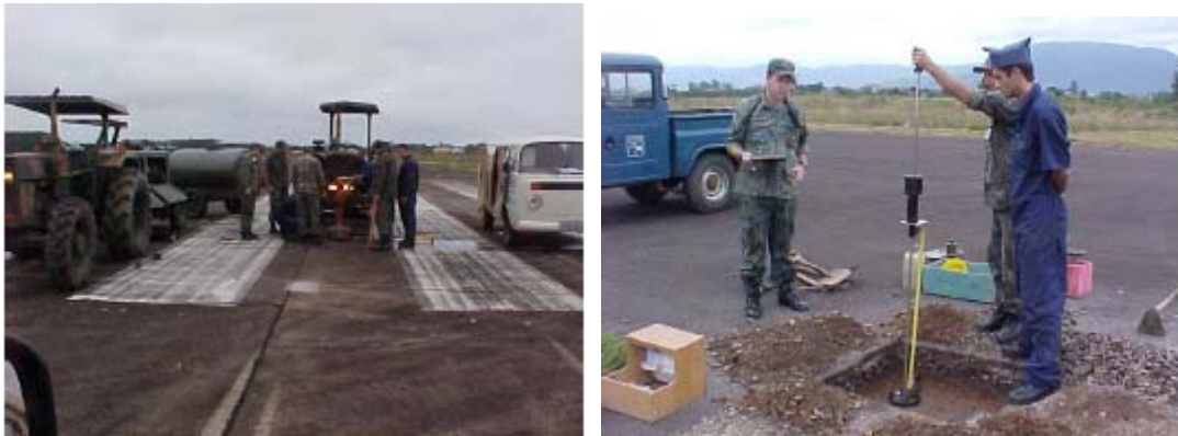
Figura 4.22: BASM: (a) Extração de corpos-de-prova; (b) Ensaio DCP-ITA
