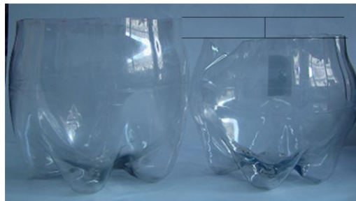
Figura 16: Recipiente de 7,5 cm de altura antes e após 50 ciclos de exposição às microondas.
