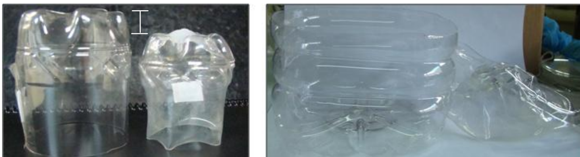
Figura 20: Comparativo das dimensões do recipiente de PET antes e após a exposição às microondas. Amostras providas de garrafas de (a) 0,5 L e em (b) 5,0 L.
