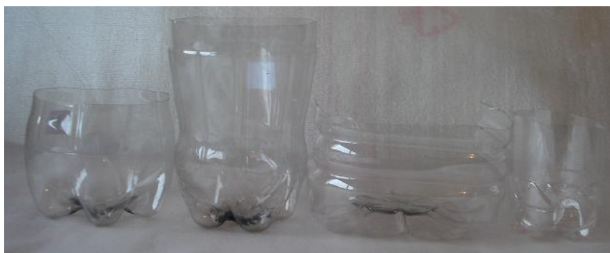
Figura 13: Embalagens ensaiadas para estudo dos quatro parâmetros. Da esquerda para direita: garrafas de PET com altura de 7,5cm e 15,0 cm; 7,5 cm e 7,5cm correspondentes aos volumes de 2L, 2L, 5L e 0,5L respectivamente.
