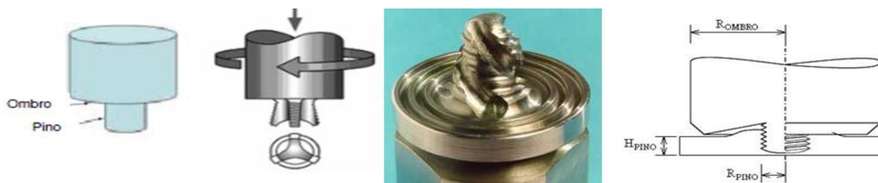
Figura 2.2: Exemplificação de ferramentas. Ombro e pino em detalhe (adaptado de Genicolo, 2007).
