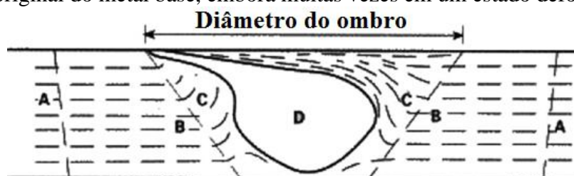
Figura 2.4: Seção transversal de uma típica junta soldada por fricção, mostrando quatro zonas distintas: (A) metal base, e zonas (B) afetada pelo calor, (C) afetada termomecanicamente, (D) de mistura (adaptado de Corrêa, 2011).
