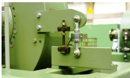
Figura 3.1 – Transdutor de força sendo usado para a medição da força de reação num braço de alavanca [Shicker e Wegener, 2002].
