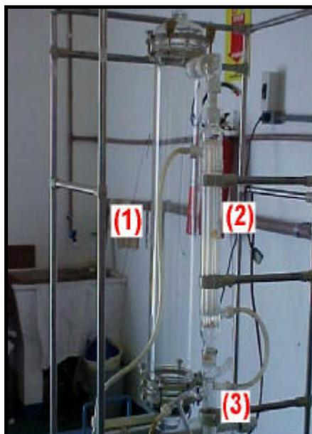
**Figura 2** Aparelho de destilação a vapor empregado no IB-UCS, (1), vaso extrator; (2), condensador e (3), vaso florentino.
