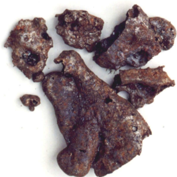
Figura 7 - Fase metálica separada durante o processo de resfriamento brusco
