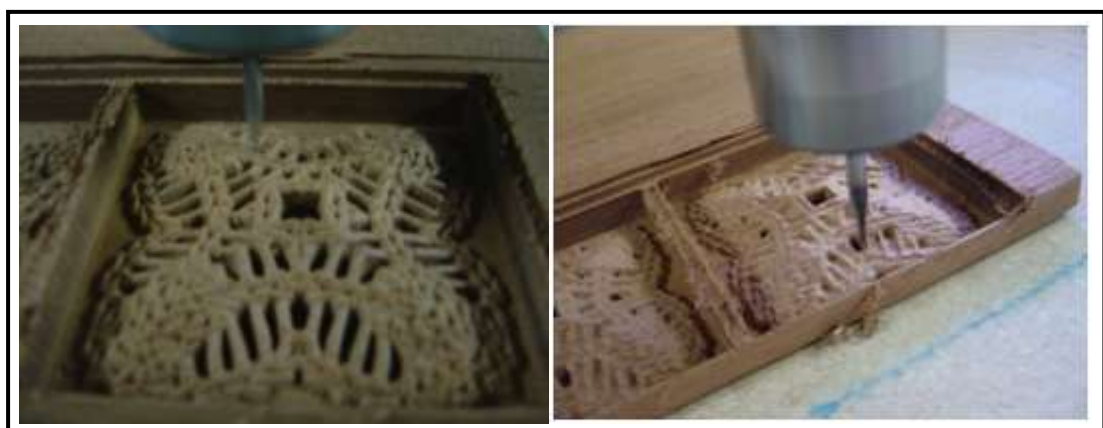
Figura 50: processo de usinagem na fresadora CNC – DIGIMILL 3D Fonte: Laboratório de Seleção de Materiais - UFRGS
