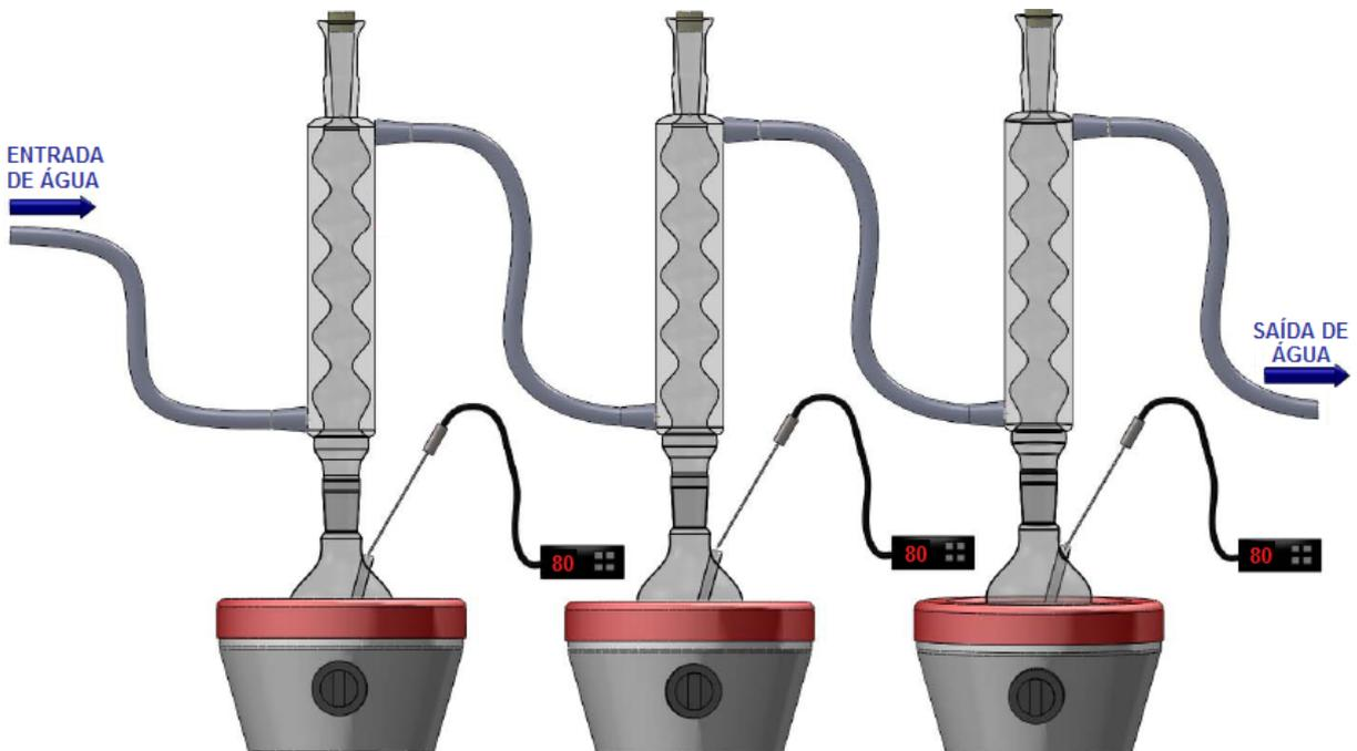
Figura 5.6. Sistema utilizado neste trabalho para o ataque dos corpos cerâmicos por ácido acético.
