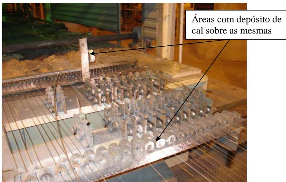
Figura 4.1 Foto ilustrativa da contaminação dos equipamentos ao longo da linha de galvanização.
