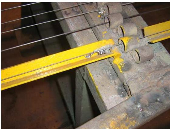
Figura 3.8 Excesso de chumbo depositado na calha de coleta para posterior pesagem.
