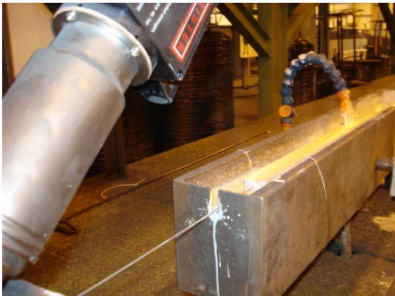
Figura 3.3 Detalhe da passagem do arame pelo tanque e saída para posterior passagem pelo soprador de ar quente com sua superfície recoberta com cal.
