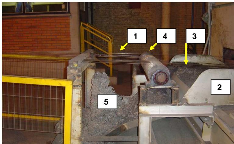
Figura 1.2 Exemplo do arraste de chumbo na saída do banho. Os arames emergem do banho de chumbo líquido e passam pelo meio de raspagem.
