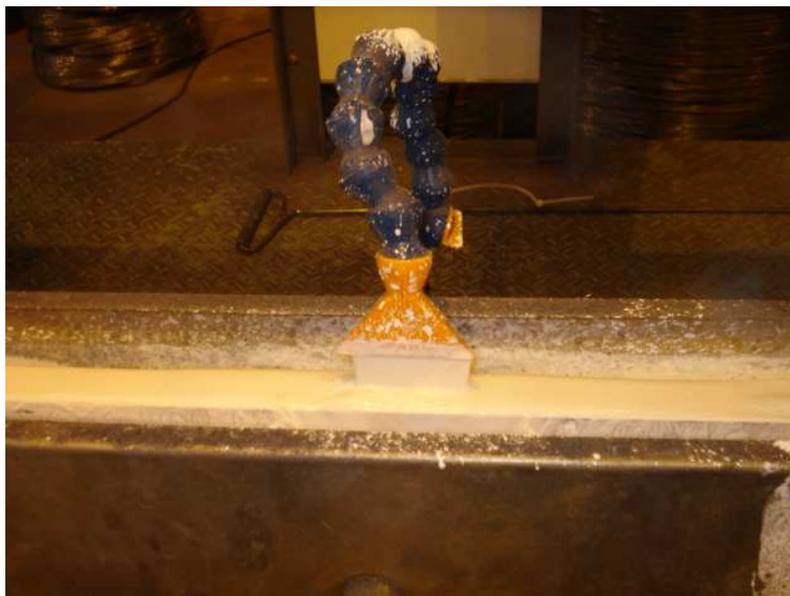
Figura 3.2 Detalhe do bico de saída do banho com a solução de  $\text{Ca}(\text{OH})_2$  preenchendo o tanque de inox.
