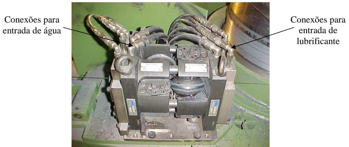
Figura 2.9 Microcassete mostrando as conexões de entrada de água e lubrificante. (EUROLLS 2005)
