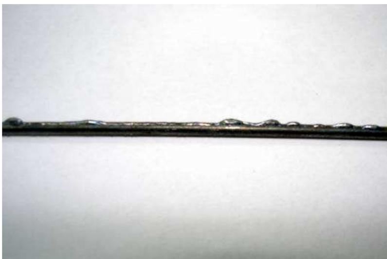
Figura 3.5 Adesão de chumbo na superfície do arame trefilado com microcassete (escala 1:1)
