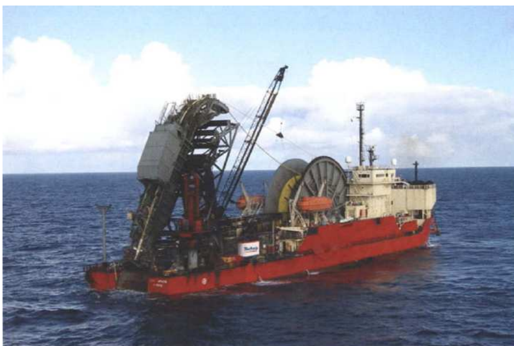
Figura 2.3 Embarcação Apache para lançamento de dutos pelo método de bobinamento (APACHE TECHNIP).
