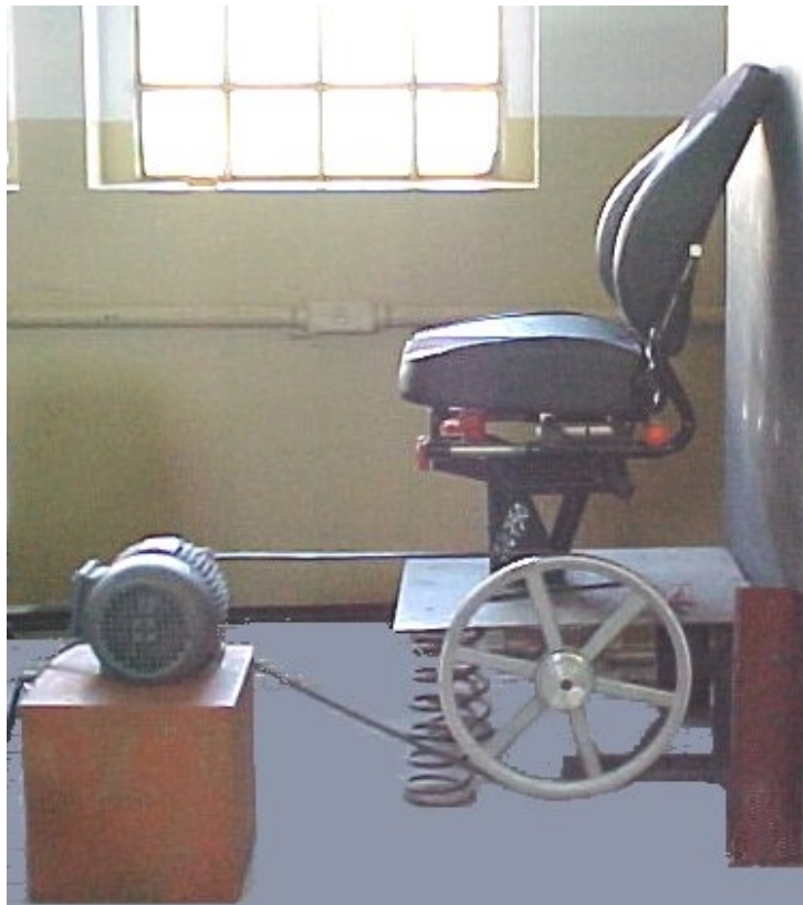
Figura 6.1 – Detalhe da mesa vibratória.
