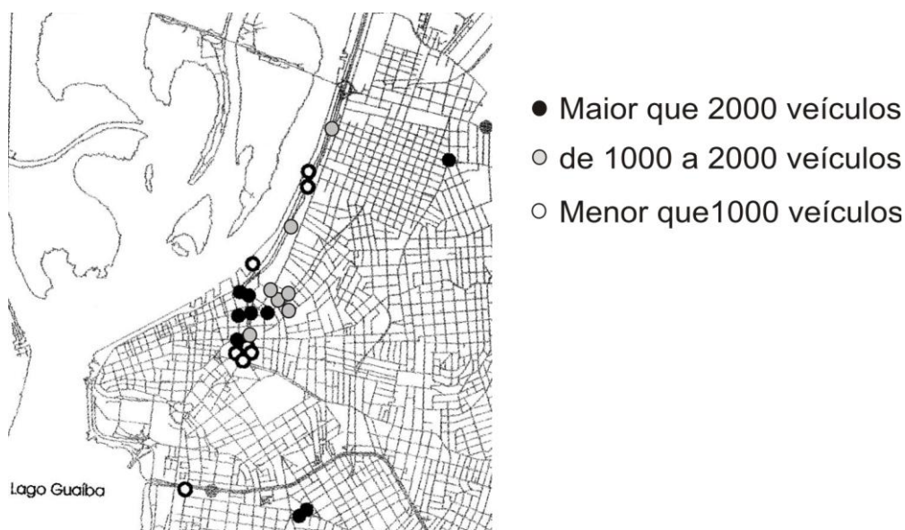
Figura 16 – Quantificação do fluxo veicular na área de estudo. Adaptado de: De Luca & Vázquez (2000)
