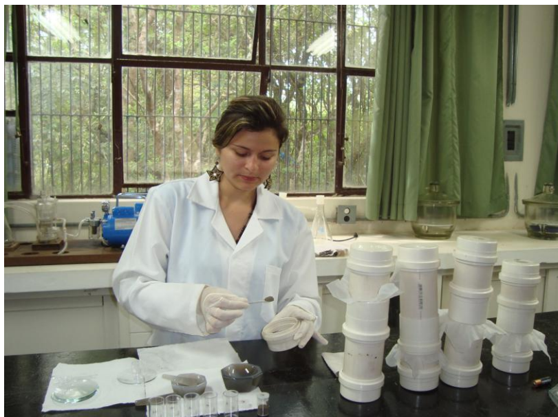
Figura 19 – Fotografia tomada durante a fase de peneiramento de amostras coletadas de sedimentos urbanos, mediante a utilização de peneiras plásticas de diversos tamanhos de aberturas.
