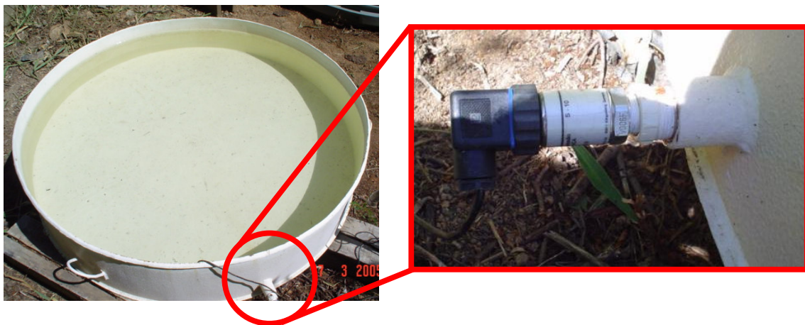
Figura 3.11. Conexão do sensor de transmissão de pressão ao tanque classe A
