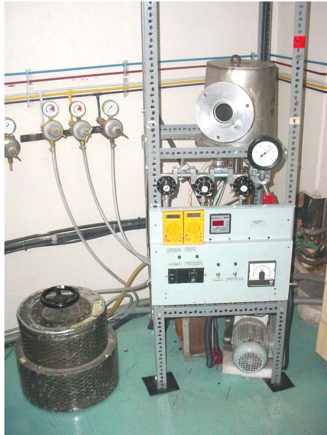
Figura 3-3 Câmara de nitretação a plasma do LAMEF- UFRGS.
