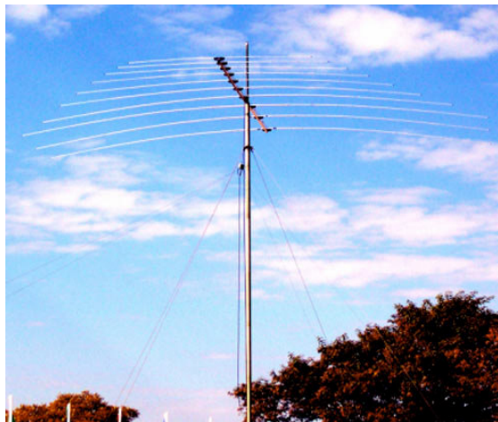
Figura 6 –Antena Log-periódica para faixa de HF. Foto obtida em [9].
