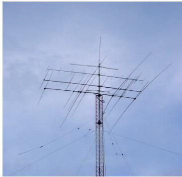
Figura 5 – Torre com quatro antenas YAGI, cada uma construída para determinada frequência. Foto obtida em [8].
