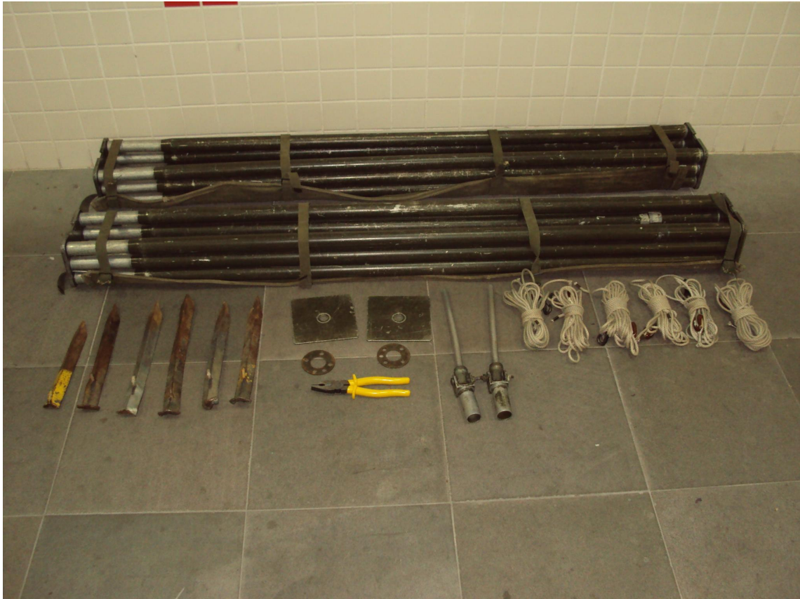
Figura 2: Mastros, bases, estais e estacas. (O alicate está colocado na figura para fins de comparação de dimensões.)
