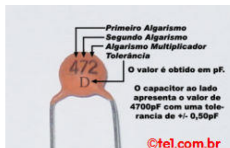
Figura 5: Exemplo de código alfanumérico de capacitores [7].
