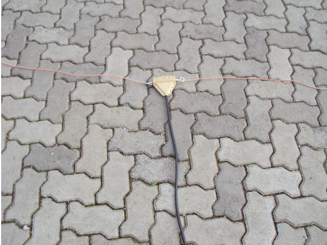
Figura 4: Antena dipolo constituída de isolador central, linha de transmissão e elementos de antena feitos de fios de cobre 2,5 mm 2 de área de seção reta. (Na imagem aparece em destaque o isolador central de cor bege, a ligação com os elementos da antena dipolo - cada fio de cobre tem aproximadamente 5 metros -, e a linha de transmissão, que é um cabo coaxial na cor preta.)
