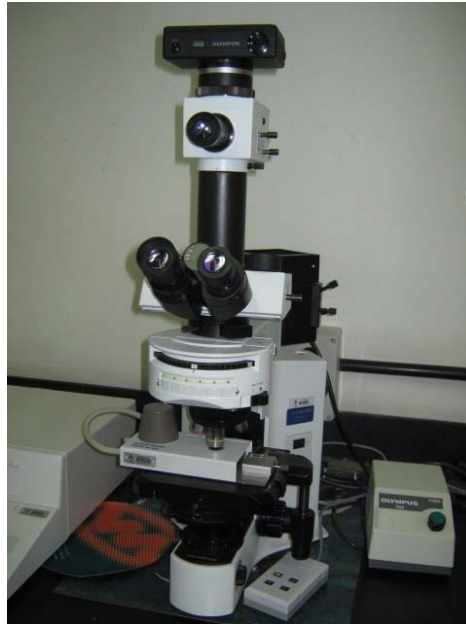
Figura 28. Foto do microscópio óptico, sistema de aquecimento e câmera fotográfica acoplada utilizados na caracterização das texturas deste trabalho.
