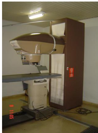
Figura 1: Irradiador de raios gama a partir de Cobalto-60.
