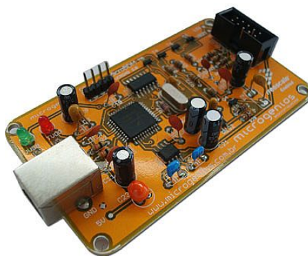
Figura 3.2 – Gravador e depurador microBDM.
