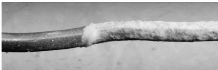
**Figura 10. Fotografia digital do eletrodo de Pt recoberto com filme de polifurfural crescido galvanostaticamente durante 90 minutos, aplicando-se uma corrente de 10 mA.**
