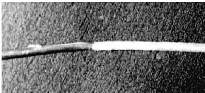
**Figura 25.** Fotografia do eletrodo modificado potenciostaticamente, durante 90 min em 2,65 V (ECS).
