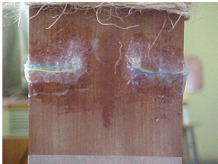
Figura 6.1: Posição de Colagem dos Extensômetros.
