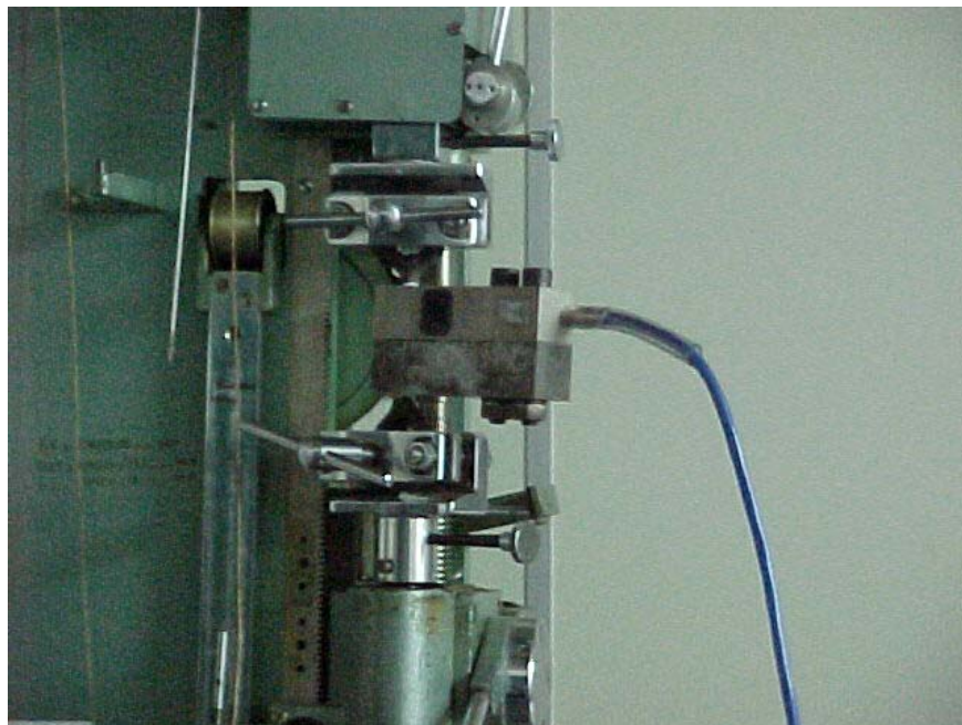
Figura 6.2: Máquina de Tração e Célula de Carga durante calibração.
