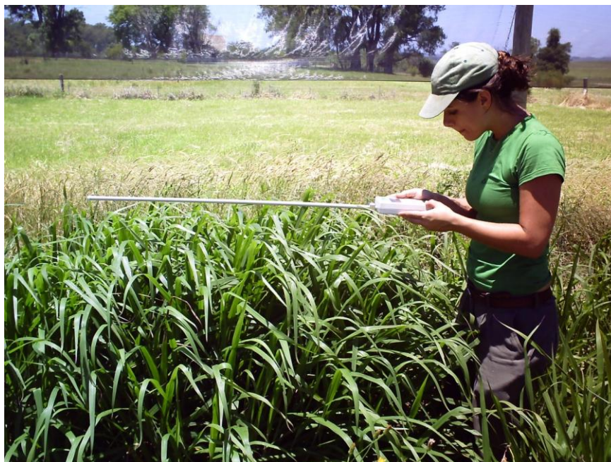
Figura 3. Medição da radiação fotossinteticamente ativa incidente ( RFA_i ) em uma subparcela de P. regnellii sob 50% de sombra. Janeiro de 2010, Bagé, RS.
