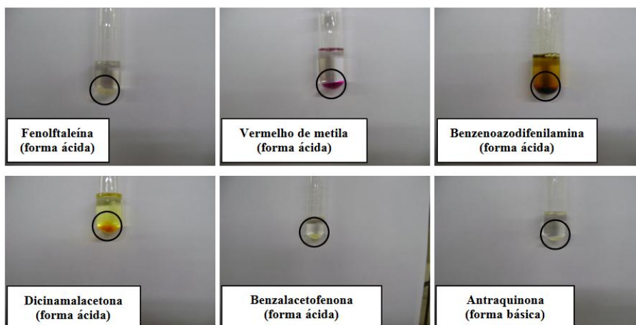
Figura 1. Ensaio de acidez de Hammett para o bissuporte de sílica-magnésia sintetizado na razão molar TEOS : MgCl 2 de 5:1.
