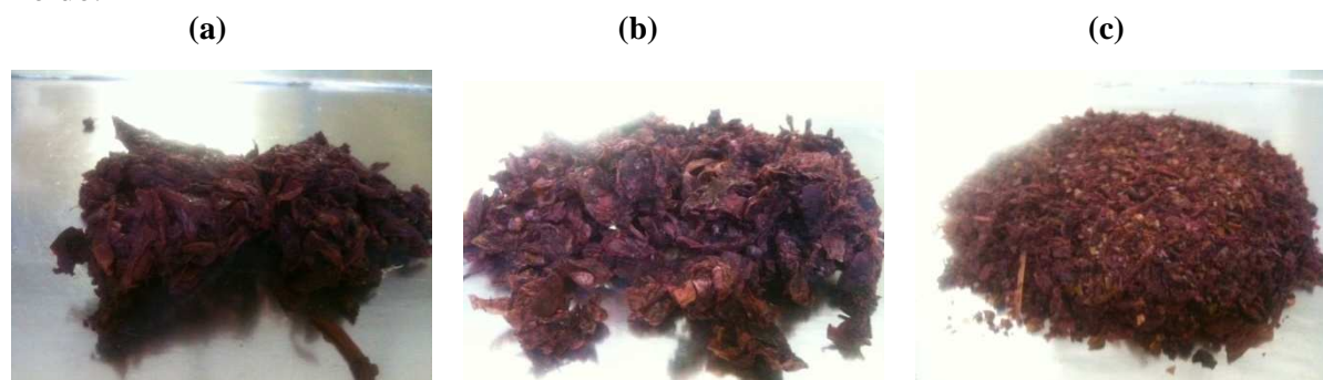
Figura 4.1 Fotografias do bagaço de uva (a) Bagaço úmido (b) Bagaço seco (c) Bagaço moído
