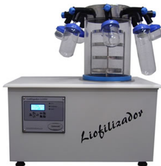
Figura 8: Imagem do liofilizador de bancada utilizado para secagem do material.
