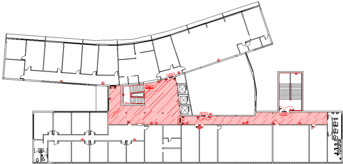
Figura 40 – Rota de fuga do terceiro pavimento
