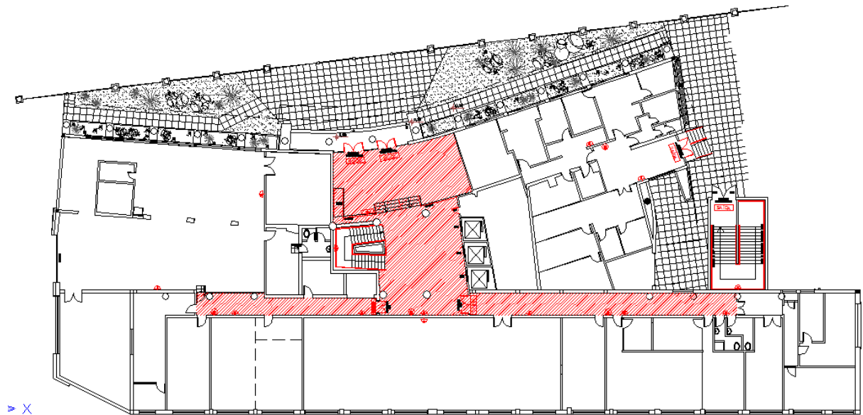
Figura 38 – Rota de fuga do pavimento térreo
