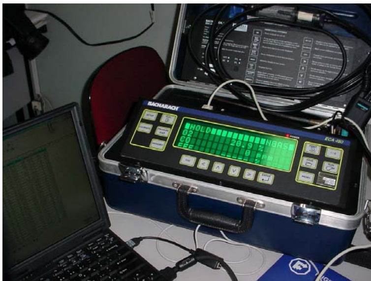
Figura 9-3 – Foto ilustrativa do equipamento Bacharach ECA-450 conectado ao notebook para a transferência de dados via interface RS-232.
