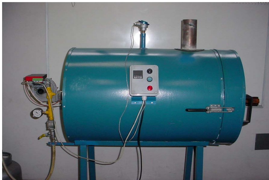
Figura 9-1 - Forno a gás utilizado nas experiências. Medidas externas: diâmetro = 675mm, comprimento = 985mm.
