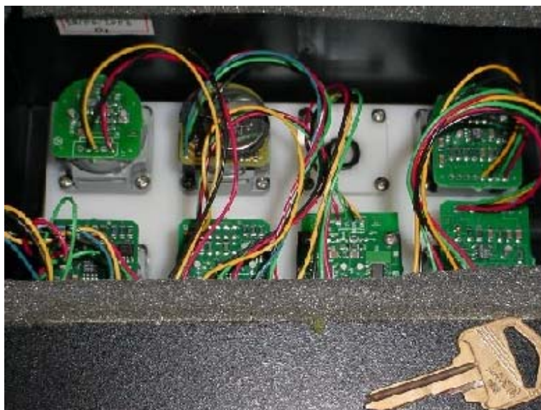
Figura 9-4 - Foto da câmara de sensores do ECA-450 com 7 sensores eletroquímicos.
