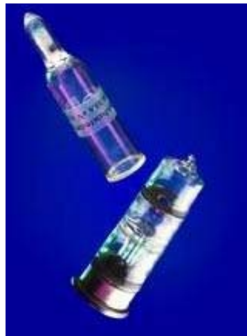
Figura 6-2 - Lâmpada ultravioleta para Detector Foto-iônico (PID). São semelhantes em dimensões e aparência externa a uma ampola de remédios. Fonte: [REF-01].
