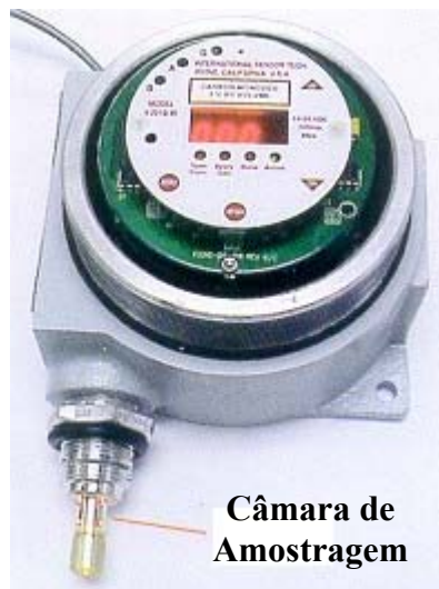
Figura 7-1 – Foto ilustrativa de equipamento que faz detecção por infravermelho. Escala aproximada 1x1. Fonte: adaptado de [Chou].
