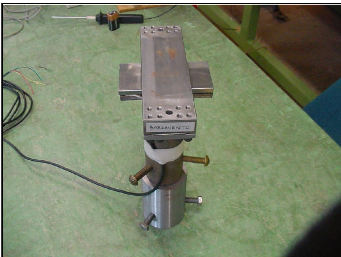
Figura 4.26: Perspectiva da Balança de Momentos Fletores
