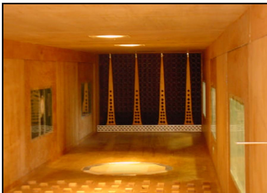
Figura 4.3: Gaveta colocada no início da câmara de ensaios para representação do vento natural
