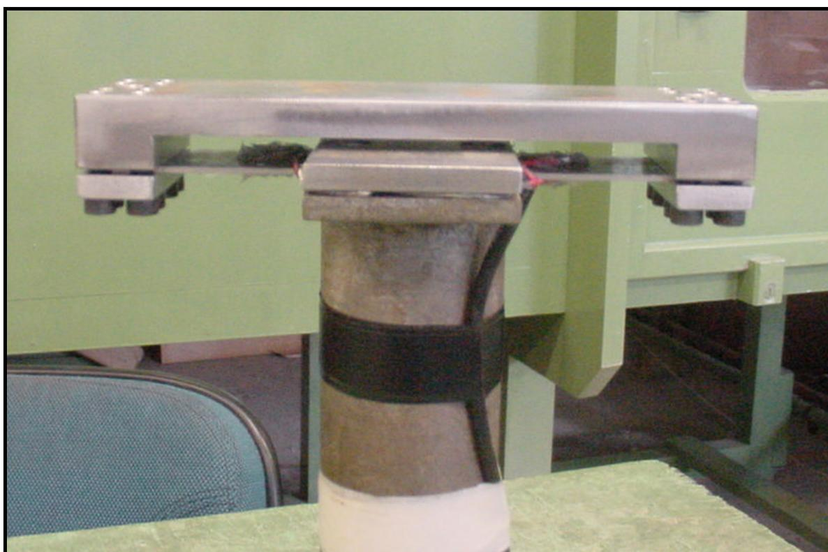
Figura 4.27: Vista lateral da Balança de Momentos Fletores
