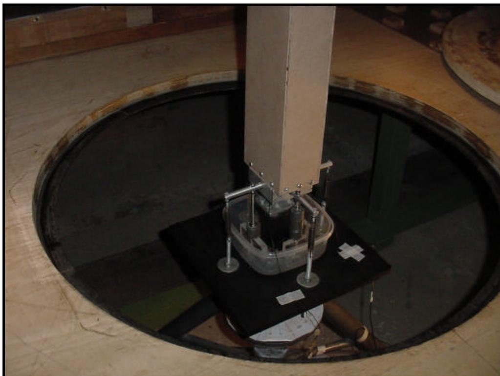
Figura 4.23: Modelo montado e instrumentado em túnel de vento.
