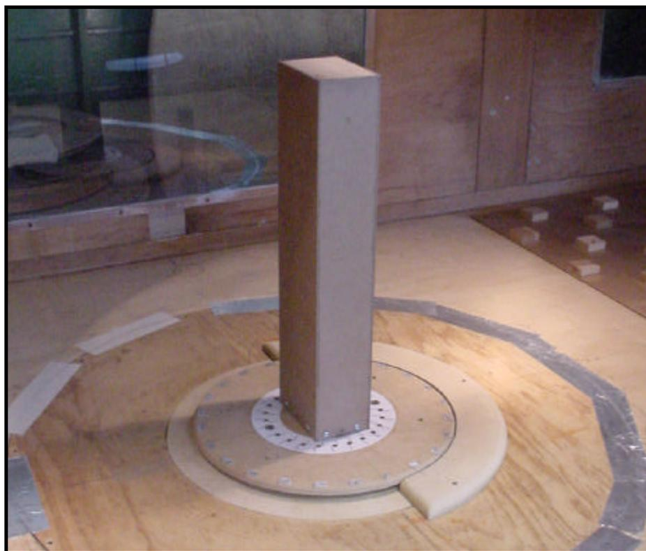
Figura 4.33: Modelo sobre a balança pronto para ensaio.
