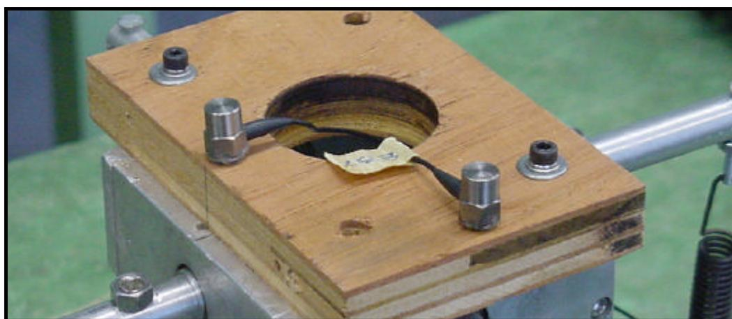
Figura 4.9: Acelerômetros fixados na parte inferior do modelo.
