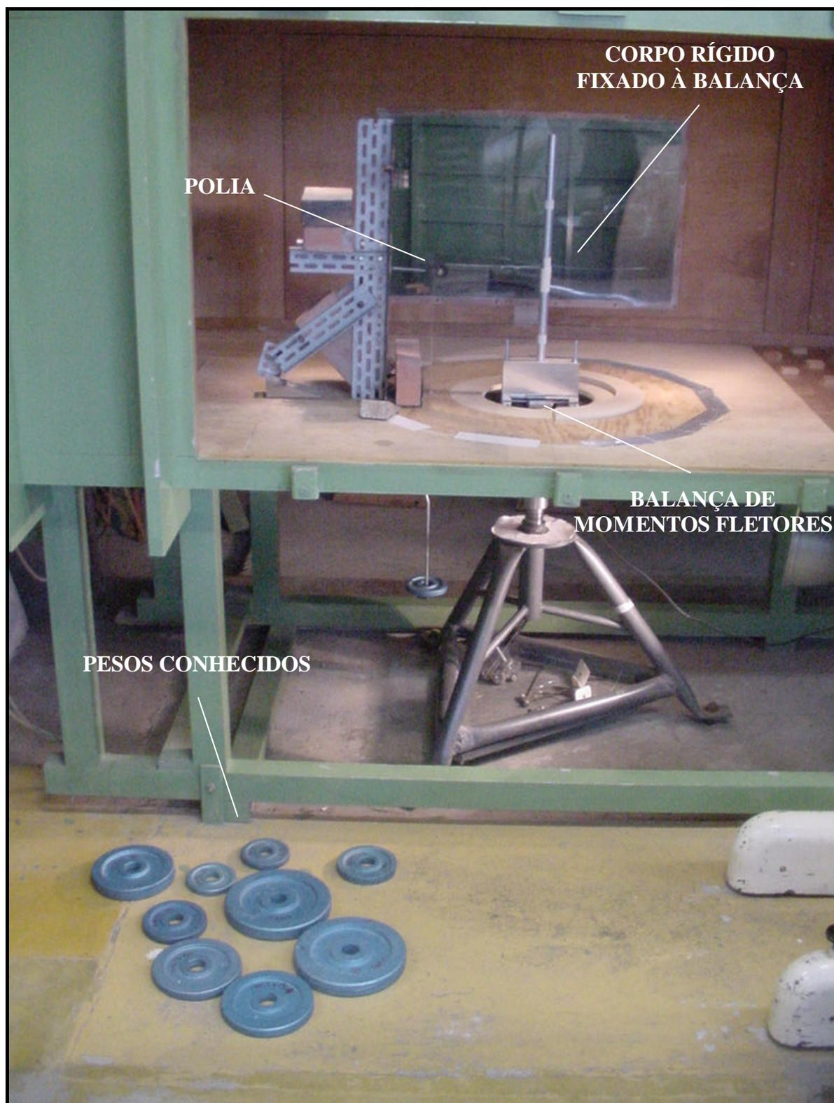
Figura 4.28: Calibração da Balança
