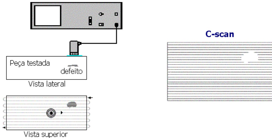
Figura 4.19 - Representação esquemática de um ensaio de inspeção por ultra-som utilizando a técnica C-scan .
