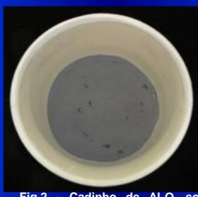
Fig.2 - Cadinho de  $Al_2O_3$  com carga.
