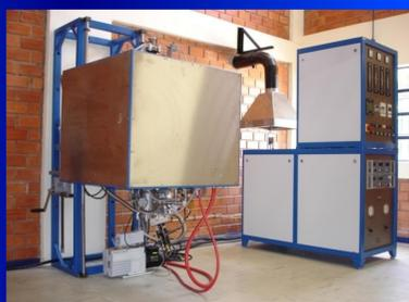
Fig.1 - Forno Elétrico Resistivo e sistema de controle.
