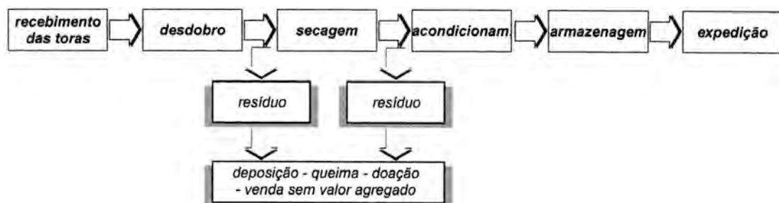
Figura 15 – Fluxograma do sistema produtivo típico de uma serraria tradicional
