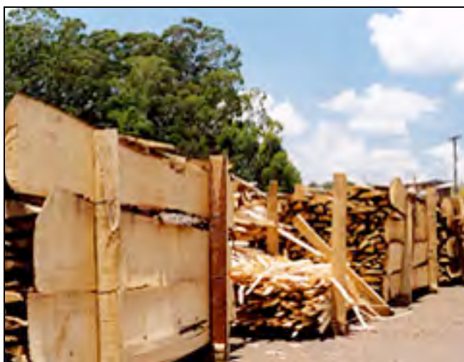
Figura 24 – Costaneiras e refilos de serraria de madeira de Pinus destinadas à queima na indústria cerâmica (do autor, São Francisco de Paula/RS)
