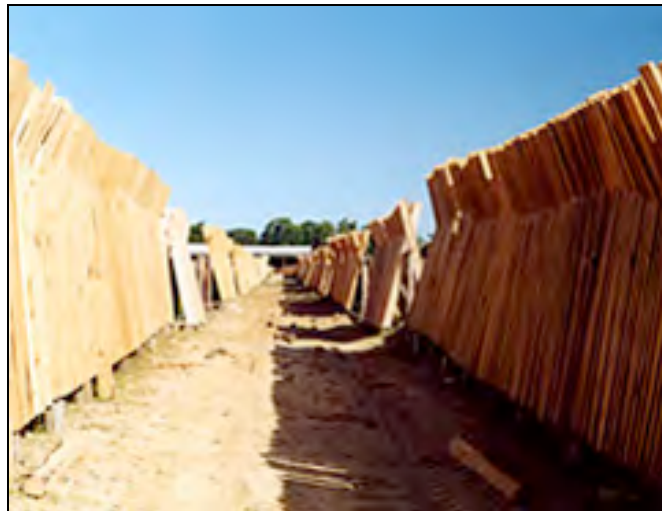
Figura 10 – Secagem natural de madeira de Pinus elliotii (Fonte: do autor, Mostardas/RS)
