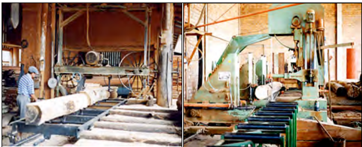
Figura 9 – Cortes alternados de madeira de Eucalipto (a) serra fita horizontal (b) serra fita vertical (Fonte: do autor, (a) Caxias do Sul/RS e (b) Viamão/RS)
