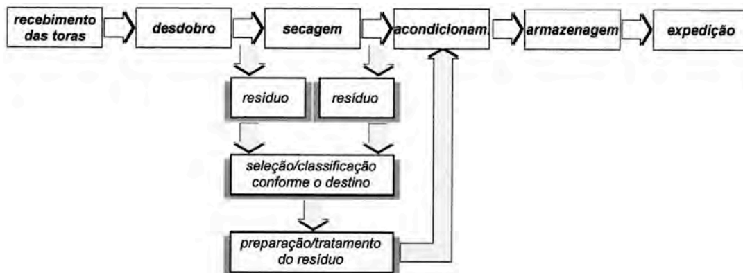
Figura 16 – Fluxograma do sistema produtivo ideal para uma serraria
