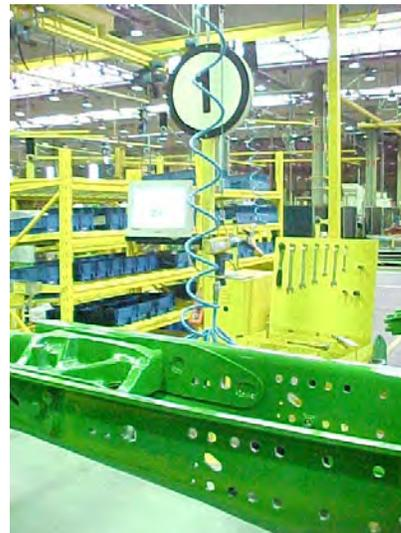
FIGURA 37 – ESTAÇÃO DE VISUALIZAÇÃO DE INSTRUÇÕES DE MONTAGEM – LINHA DE TRATORES
