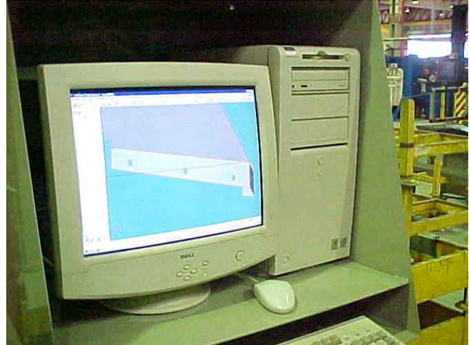
FIGURA 36 – ESTAÇÃO DE VISUALIZAÇÃO DE MODELOS DERIVATIVOS NO CHÃO DE FÁBRICA
