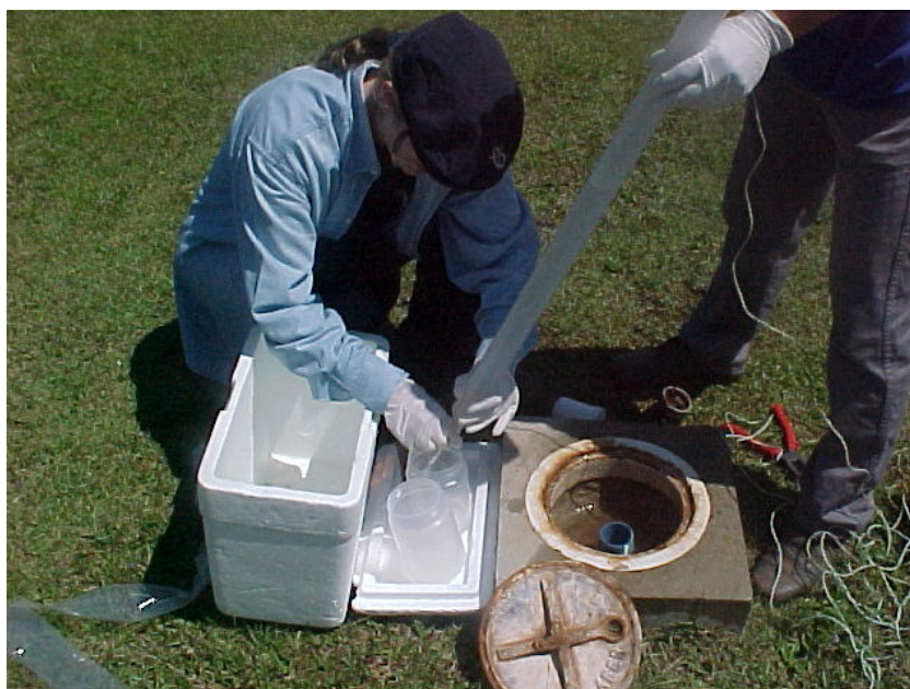
FIGURA 16: Coleta de amostra da água subterrânea
