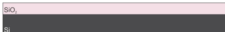
Figura 3.4 Resultado da oxidação térmica. Camada de dióxido de silício com espessura de 440 nm.
