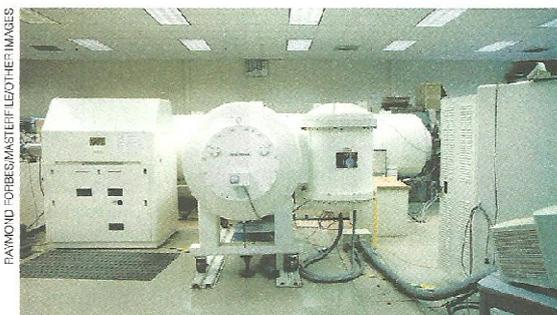
Espectrômetro de massa, aparelho que mede a massa atômica dos elementos químicos presentes em uma amostra.
