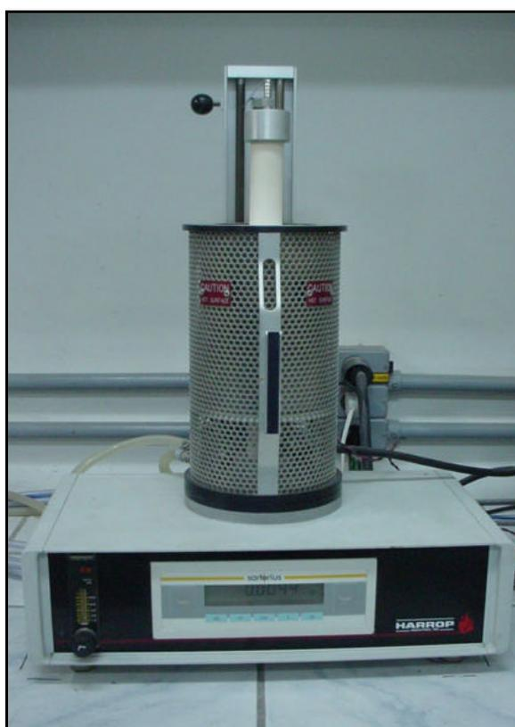
**Figura 4.16** – Equipamento utilizado no ensaio de análise termo-diferencial
