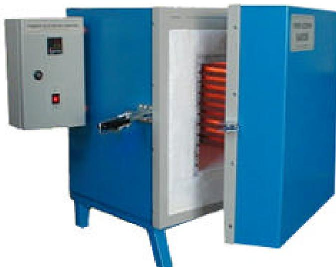
**Figura 4.9** – Forno elétrico empregado para o aquecimento das amostras
