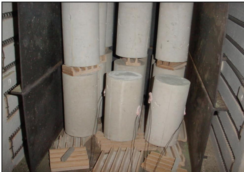
**Figura 4.17** – Sistema de monitoramento da temperatura
