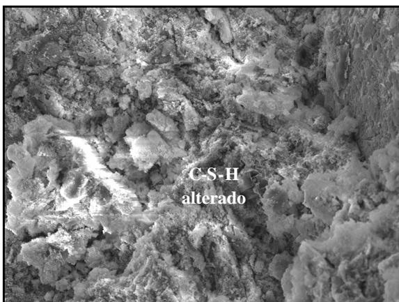
**Figura 5.46** - Concreto de alta resistência à 900°C (x1000)
