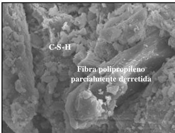
**Figura 5.58** - Concreto de alta resistência com 10% sílica-ativa à 200°C (x1100)
