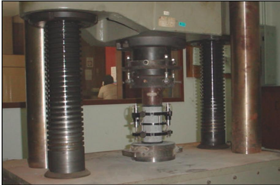
**Figura 4.11** – Ensaio para determinar o módulo de deformação.
