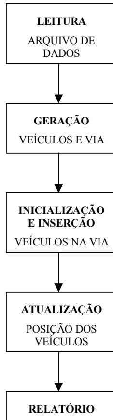
Figura 3.2 – Estrutura do modelo de simulação.
