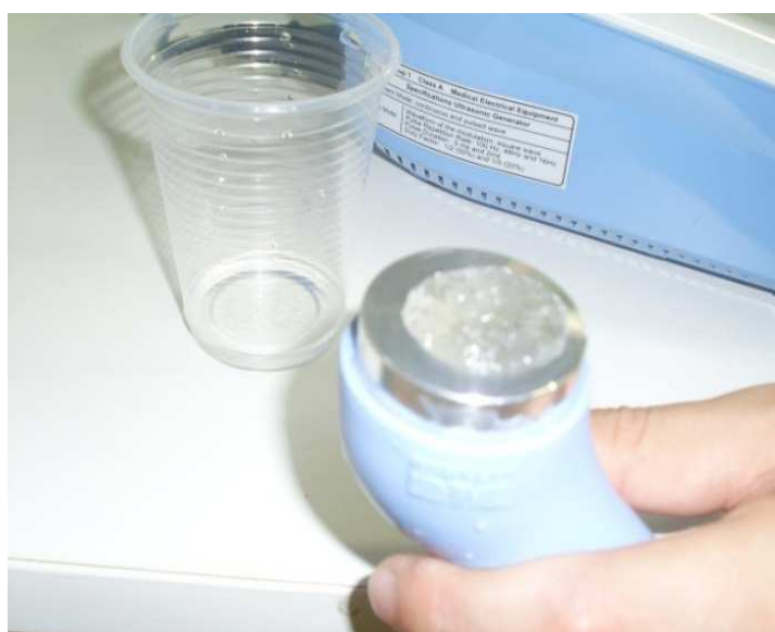
Foto 5: Vibração ultrassônica de um transdutor
