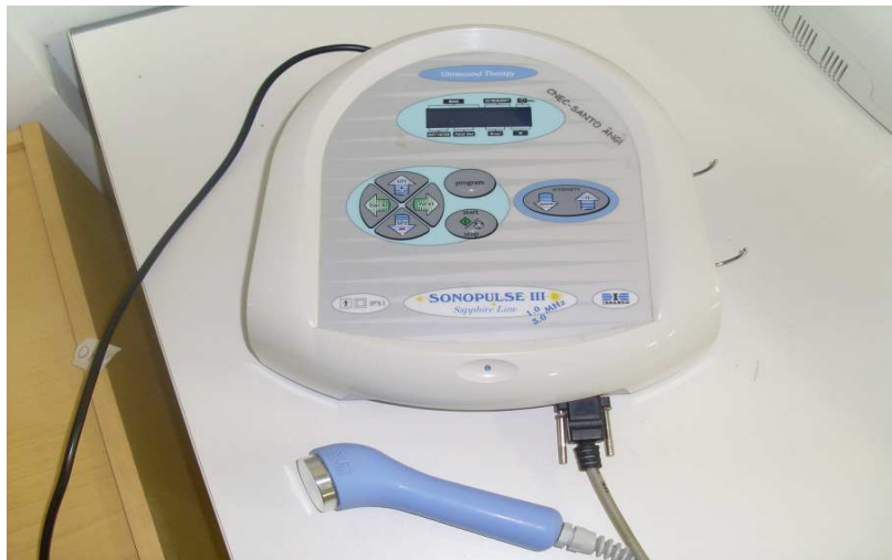
Figura 1: Equipamento de ultrassom utilizado em fisioterapia com frequência de 1MHz e 3MHz
