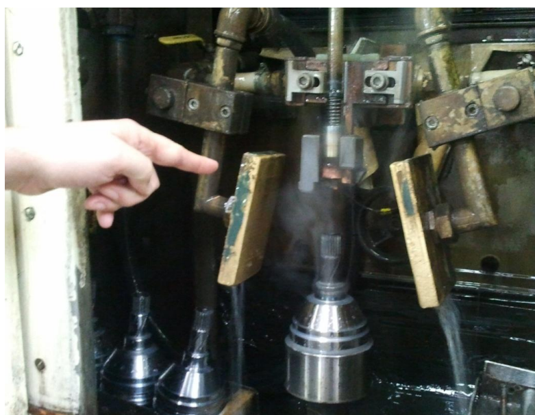
Figura 15 – processo produtivo do semi-eixo no uso do indutor Fonte: dados da pesquisa
