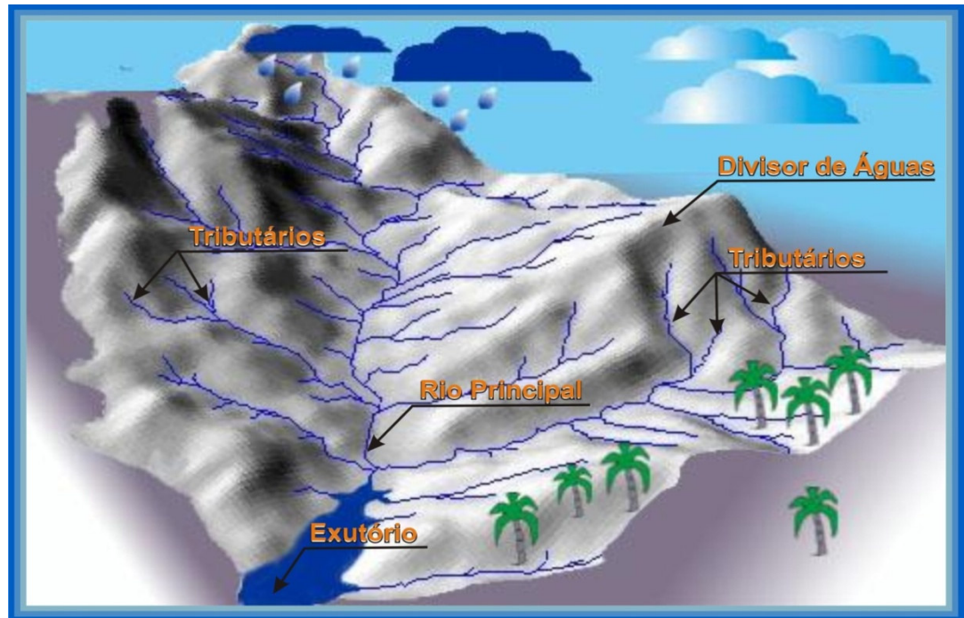
Figura 7: Desenho esquemático de uma bacia hidrográfica (Fonte: RIO GRANDE DO SUL. SEMA, 2010).
