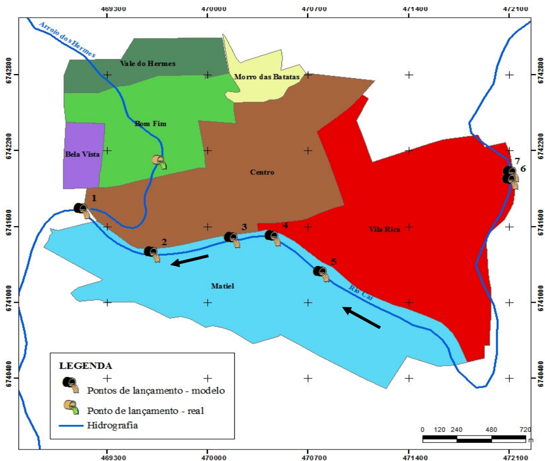
Figura 45: Pontos de lançamento das redes pluviais no rio Caí, no trecho que banha o município de Feliz.
