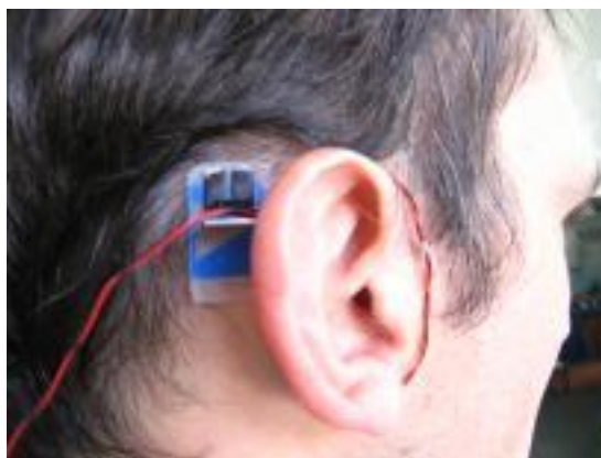
Figura 5.10 – Dispositivo de fixação do acelerômetro para as medições de vibração na cabeça
