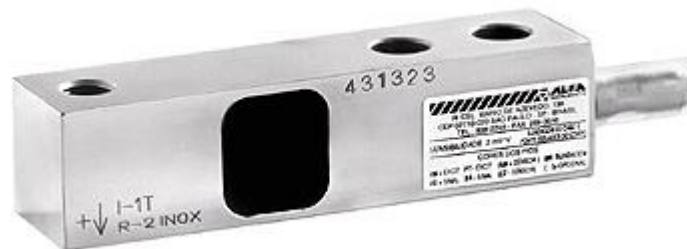
Figura 5.6 – Célula de carga modelo I-500 (Alfa Instrumentos, São Paulo) utilizada nas medições de força.
