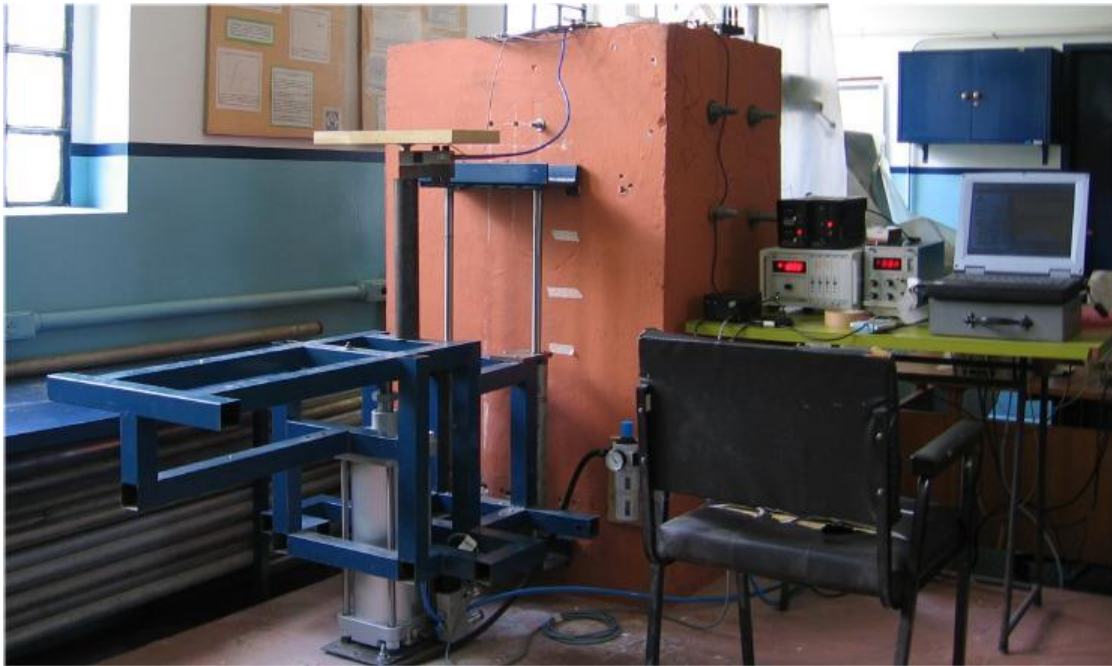
Figura 5.2 – Mesa vibratória montada e sistema de controle e aquisição de dados
